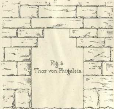
Thoröffnungen mittelst Ueberkragung bedeckt. (Sog. falsche Gewölbe)
