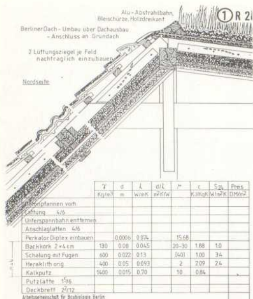
Ausgebauter Dachraum mit Grassdach, Dachaufbau
